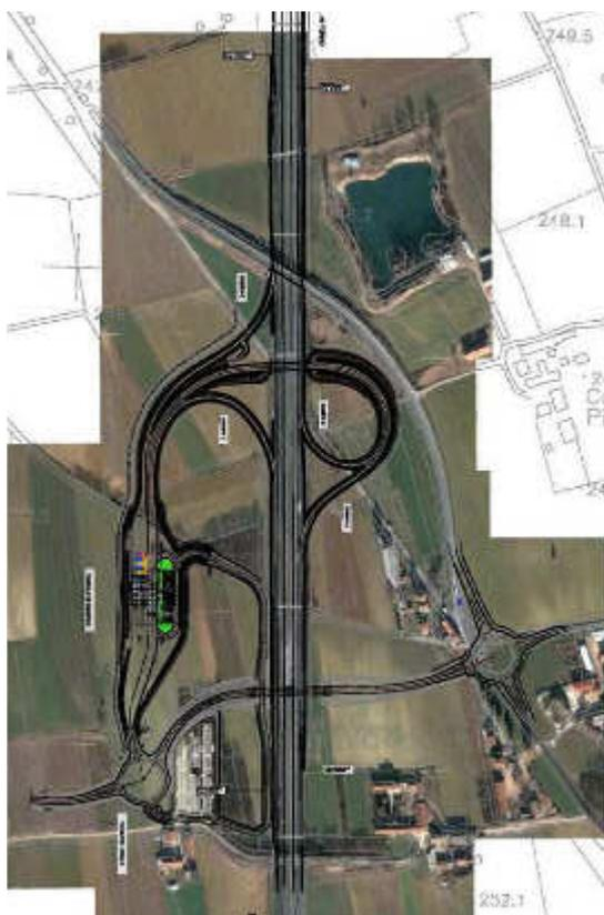
Per quanto concerne il nuovo svincolo autostradale di Carmagnola Sud, da progetto questo risulta essere situato al km 17+000 dell'autostrada A6 Torino-Savona. Lo schema funzionale dello svincolo è del tipo a trombetta con quattro rampe di tipo monodirezionale di connessione diretta alla carreggiata Nord e indiretta alla carreggiata sud e con una rampa bidirezionale sovrappassante l'autostrada A6 che realizza il collegamento di ingresso/uscita in direzione Sud.
