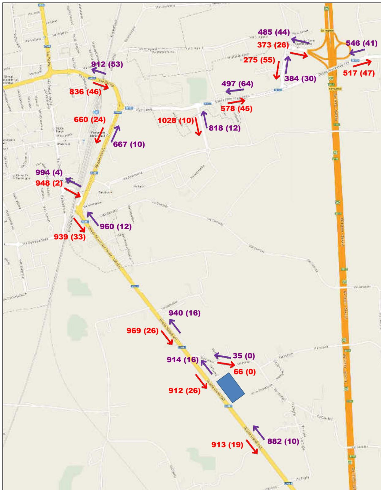
Figura 45 – Scenario di progetto 1: Livello di Servizio e rapporto V/C in sezione
