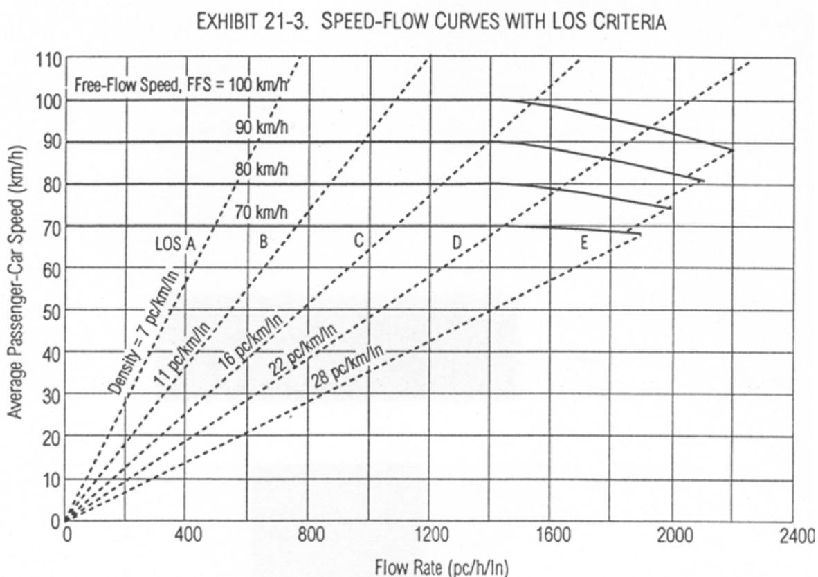
Il metodo di calcolo è illustrato nel capitolo 21 del manuale HCM, alle pagine 1-11; nel seguito è riprodotto un foglio di calcolo che riporta la metodologia di calcolo originale dell'HCM 2000 utilizzata per l'analisi di una strada a due corsie per senso di marcia.
