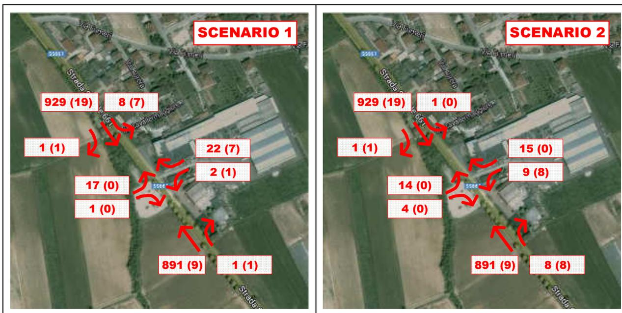
Come sopra descritto, nel passaggio dallo scenario 1 (figura di sinistra) allo scenario 2 (figura di destra) si assiste allo spostamento dei flussi veicolari pesanti in accesso ed in uscita dal quadrante nord al quadrante sud. In particolare:
