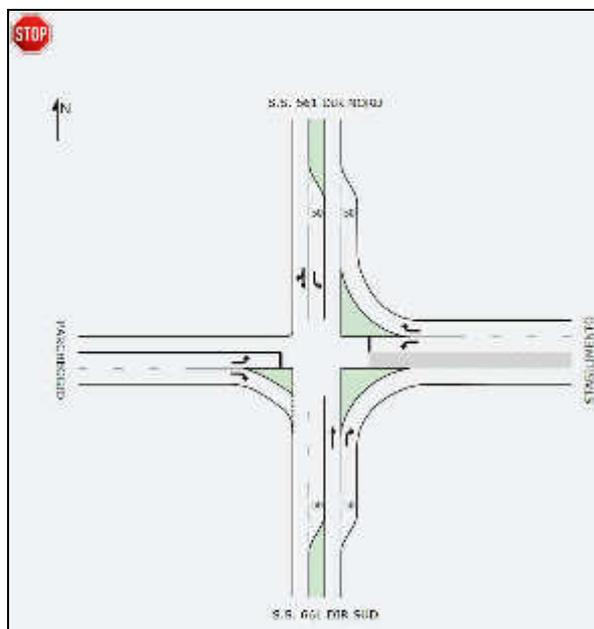
A tal proposito, ed a titolo puramente indicativo, si riporta nella figura a fianco la schematizzazione dell'intersezione posta a servizio dello stabilimento, e rivista alla luce delle osservazioni prodotte, che è stata utilizzata per procedere ad una preliminare verifica tramite il software SIDRA. Con tale conformazione quindi non solo si eliminano code e perditempo lungo la ex S.S. 661, ma soprattutto si acquisiscono rinnovati standard di sicurezza lungo l'arteria.
